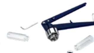
Verschließzangen mit verstellbarem Bördeldruck und variabler Bördelhöhe. Jeder Verschließzange liegt ein Inbusschlüssel bei, mit dem das Innere des Bördelkopfes herauf- bzw. heruntergefahren werden kann.
